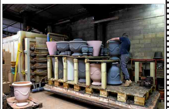
■ La cuisson dans le four est portée à 1 000° C.
