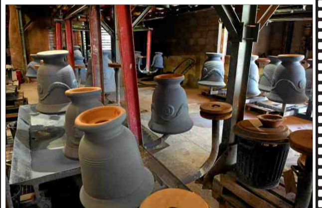
■ Sur la chaîne d'émaillage sont apposés les différents émaux qui donneront les couleurs spécifiques aux vases.
