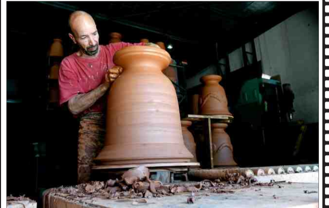
■ Le calibrage est la forme du vase tirée du bloc de terre. Après cette étape, le potier fixe le pied sur la cloche.
